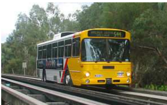
Figur 2.17 BRT-systemet O-Bahn Busway i Adelaide, Australien
