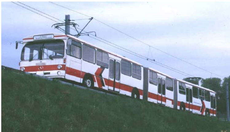
Figur 2.1 O-Bahn fordon på bana och med strömavtagare. Fordonet kan köra (automatiskt) i två riktningar.
